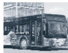
2007 Diesel-elektrischer Hybrid-Stadtbuss mit Ultracap-Speichersystem
