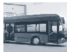
2000 Diesel-elektrischer Hybrid-Stadtbuss mit NiMH-Batterie
